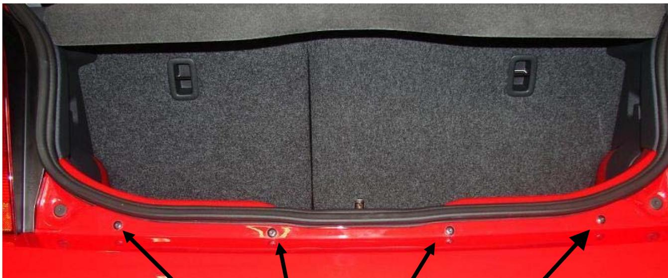
Entfernen Sie diese vier 25er Torx Kunststoffschrauben
