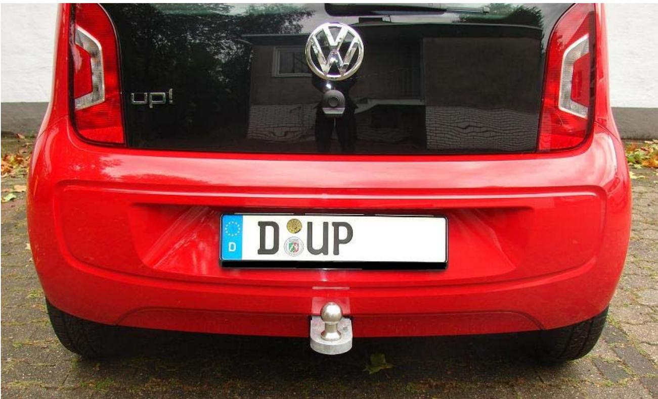
Nun wird der Kugelkopf eingesetzt und mittels Wellenscheibe und Hutmutter bei 120Nm festgezogen.
