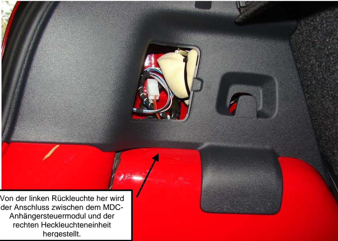
Führen Sie den Anschluss für die rechte Leuchte durch den hinteren Querholm zur rechten Rückleuchte.
