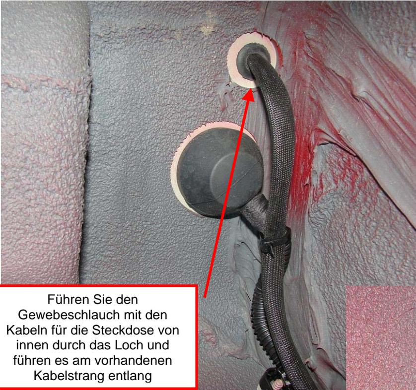
Führen Sie den Gewebeschlauch mit den Kabeln für die Steckdose von innen durch das Loch und führen es am vorhandenen Kabelstrang entlang
