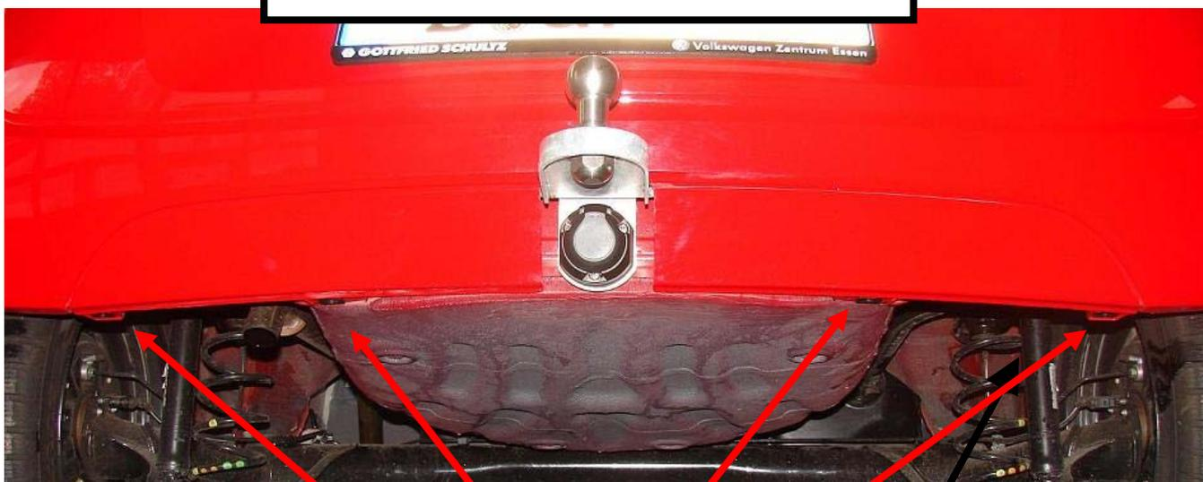
Entfernen Sie diese vier 15er Torx Kunststoffschrauben
