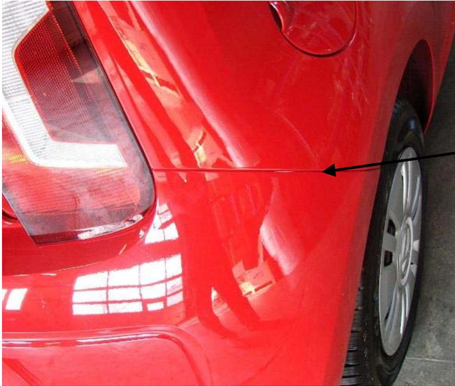
Auf beiden Seiten des Kotflügels an diesen Stellen ziehen und so den Kotflügel austrasten. Die Heckschürze zur weiteren Bearbeitung weglegen. Nun die gesamte Heckverkleidung nach hinten ziehen und den Stecker der Kennzeichenbeleuchtung entfernen
