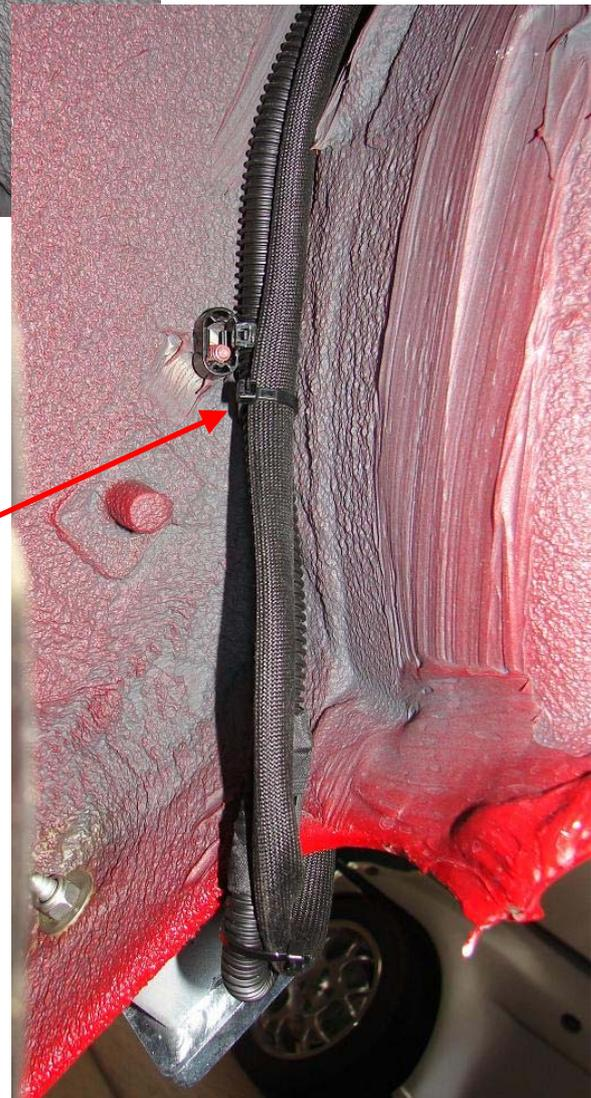
Befestigen Sie den Schlauch mittels Kabelbinder am vorhandenen Kabelstrang.
