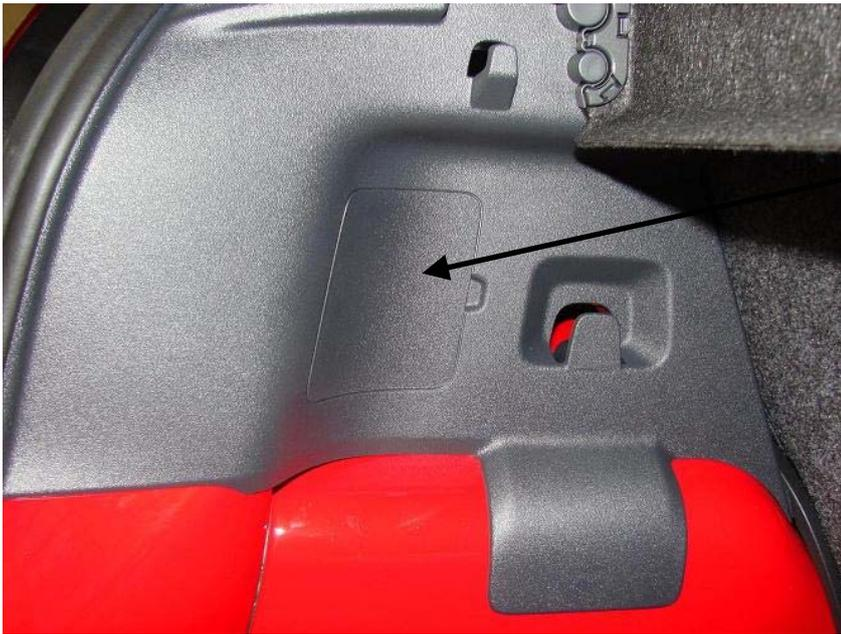
Entfernen Sie diese Klappe auf beiden Seiten
