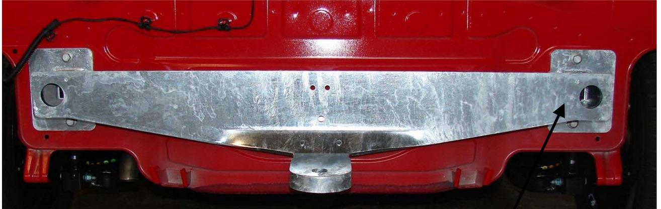
Setzen Sie den Kupplungsträger ohne Kugelkopf auf das Heck und schrauben ihn mit den vier Originalbundschrauben sowie den zwei zusätzlich gelieferten Originalbundschrauben mit 25 Nm fest
