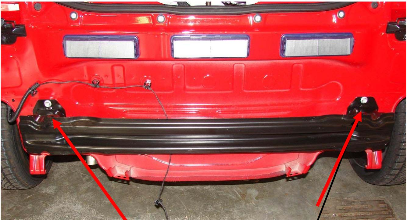
Entfernen Sie diese vier 8mm Sechskantbundschrauben und nehmen den Stoßfänger ab. Die Stoßfänger wird nicht mehr benötigt. Die Schrauben werden für die Montage des Kupplungsträgers wieder benötigt !
