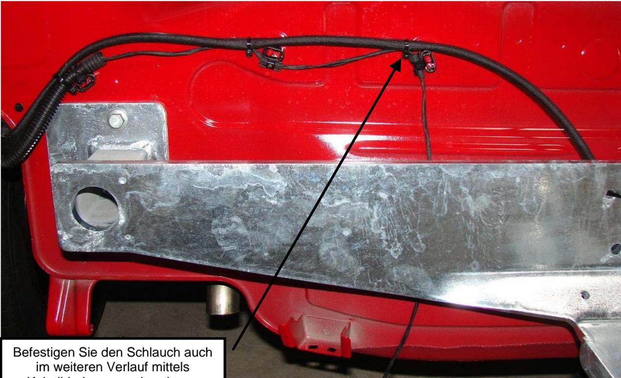
Befestigen Sie den Schlauch auch im weiteren Verlauf mittels Kabelbinder am vorhandenen Kabelstrang.
