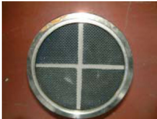
Fig 9. Udløbssiden af et brugt filter
