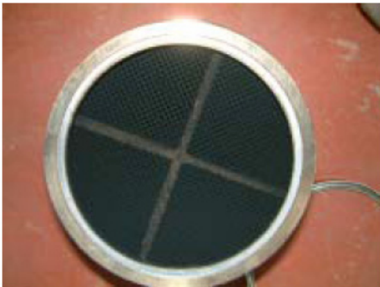
Fig 8. Indløbssiden af et brugt filter
